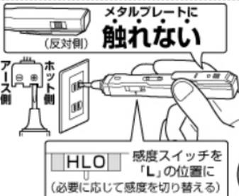
感度スイッチを「L」にします。(必要に応じて感度を切替)コンセントの穴にプローブ先端を差し込みます。この時メタルプレートに触れないでください。
