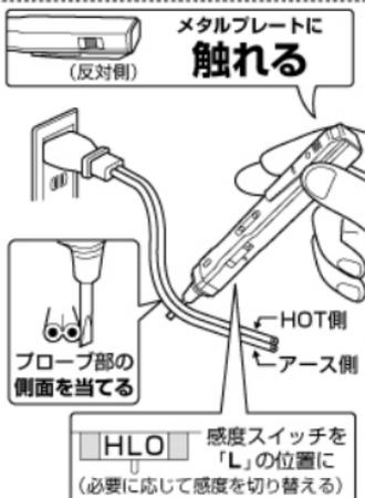
感度スイッチを「L」にします。(必要に応じて「H」に切替)片手をメタルプレートに触れて、コード被膜上にプローブの側面をあてます。
