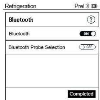
4 測定前に都度指定のスマートプローブを接続する場合は、Bluetooth マニュアル接続を選択して 【Menu/Enter】 を押して ON にしてください。モード選択時にスマートプローブの検出を行います。OFF に設定すると、スマートプローブの電源を入れた際に自動的に接続されます。
