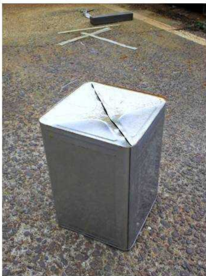
④ 作業①②で切り込みを入れた後に、中央部を少し押してあげると楽に潰せます。
