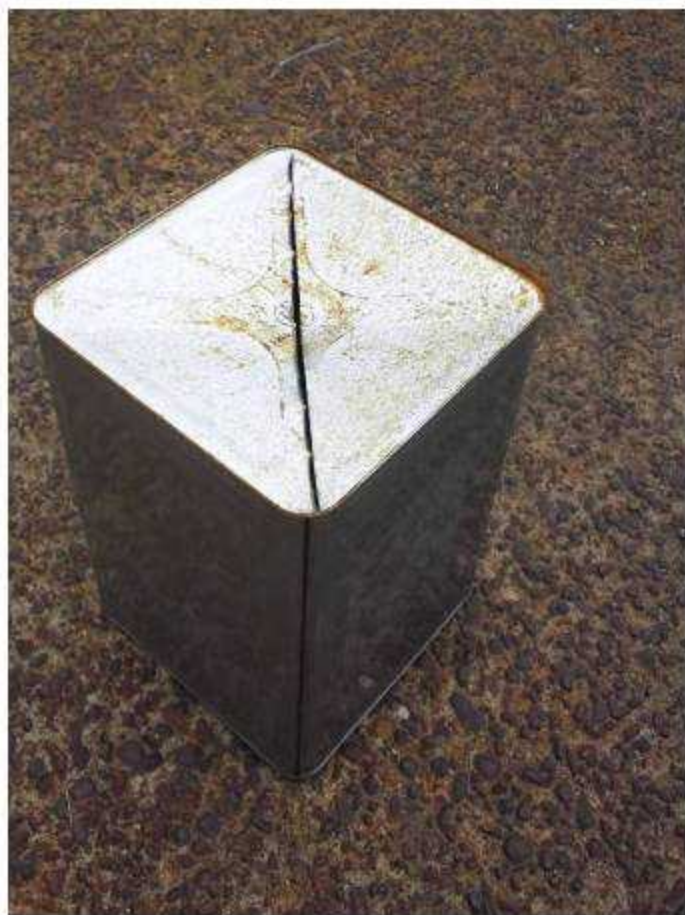
③ 下部も上部と同じ方向で対角に刃をあて、切り込みを入れます。
