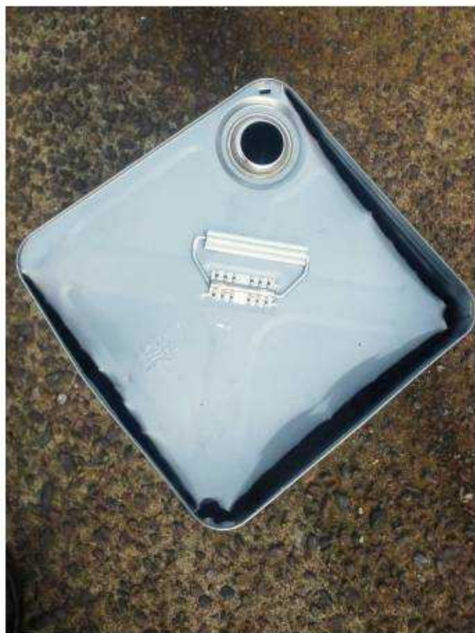
① '缶上部のふちに沿って3方向で切り込みを入れます。
