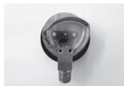
圧力が掛かり破損したゲージ
