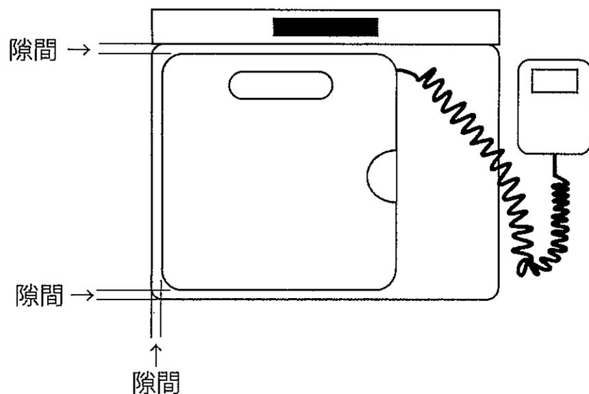
秤の台がケースの内側に接触しないように置いて計量して下さい。
