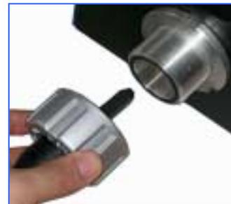
5. フレキシブルシャフトの反対側の末端に、適切な先端工具を取り付けます。
