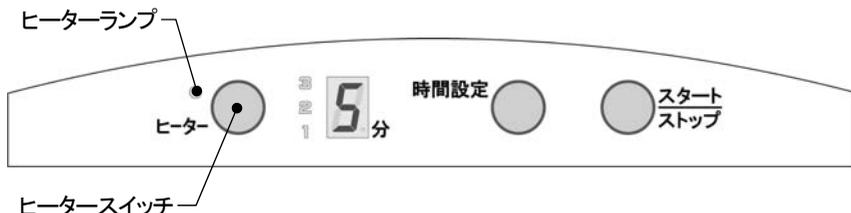
※洗淨槽内の水温は約 50°Cになるよう制御していますが、洗淨中はヒーターを使用していない時でも水温は上昇しますので 50°C以上になることがあります。また、室温や洗淨液などの影響で水温が変動することがあります。
