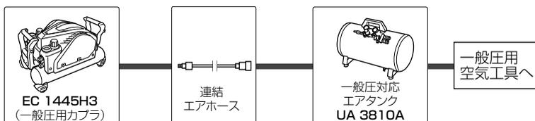
● 本機の高圧専用エアタンク接続口に、【UA 545H2】に同梱の接続用カプラ、別売の補助タンク用ホース、およびカプラ接続用継手を使用して、高圧エアタンク【UA 545H2】を接続できます。
