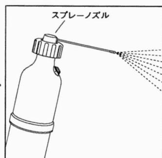
④付属のスプレーノズルを取り付け、噴射方向を確認し、目的物から約20cm離してスプレーしてください。噴射力が弱くなった場合は、エアを追加で充填してください。
