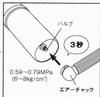
③エアーチャックを、本体の底のバルブに押し当て、エアを充填してください。約3秒で満タンになります。※コンプレッサーの圧力は0.59~0.79 MPa (6~8 kg/cm<sup>2</sup>)に設定してください。
