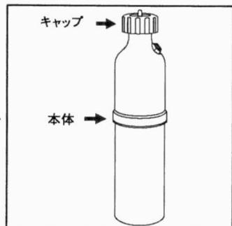
②本体上部を取り付け、本体とキャップが最後まで締まっている事を確認してください。※締まっていない場合、エアー充填の際に中の液が噴き出す恐れがあります。
