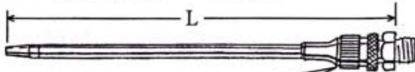
ノズルローレット部のネジ調整で量の調節が可能!!
