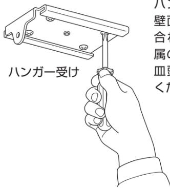
ハンガー受けを天井または柱、壁面などの取り付けたい場所に合わせて取付下孔を加工し、付属のビス(ボルト)または市販の皿頭ビスなどで確実に固定してください。(ビスセット付属)
