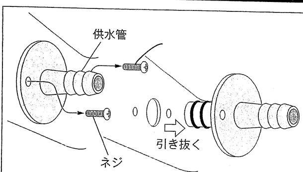
1. 水道側の側板にある供水管のネジ（2ヶ所）
