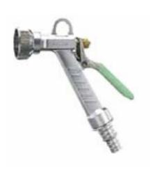
材質…亜鉛、黄銅 全長…200mm ノズル径…38mm 適合ホース…内径15mm、18mm 使用圧力…0~0.6MPa 使用流体…上水道水 レバーの握り方により直射・噴霧・ 止水の切替が可能です。
