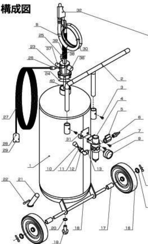
ドライ/ウェット切替ノズル構成図
