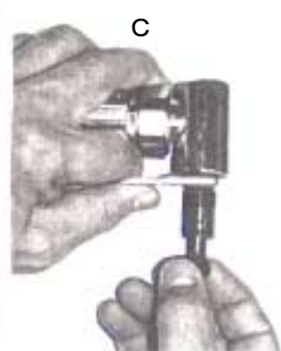
C 軸に合ったシャンクアダプ ターを取り付けます。
