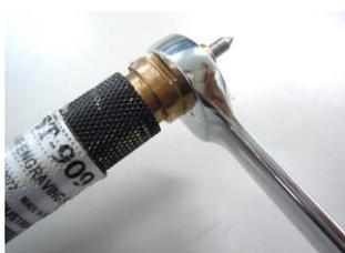
11mmのスパナ等を用意し、先端部分の溝に合わせて先端を取り外して下さい。
