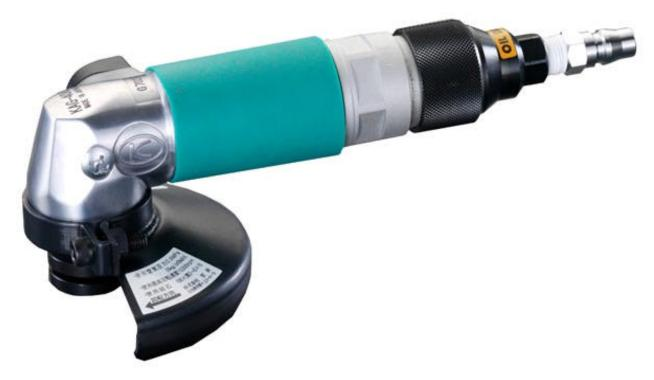
全長…194mm 重量…0.9kg 使用圧力…0.6MPa エアー消費量…350L/min 無負荷回転数…12,000rpm 吸入口…Rc(PT)1/4 使用コンプレッサー…2.2kw 適合砥石…直径:100mm、穴径:15mm
