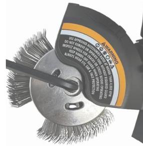
②付属の六角レンチを使用し、時計方向に回してクランプボルトでホイールを固定して下さい。
