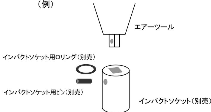
必ずインパクトソケット用ピン、リングを併用してください。
