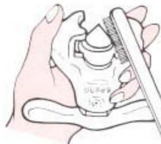
コーンに銅カスが付着した時は本体からクランプバーをはずして(クランプバーの取外しはエンドピンをノックピンポンチで抜けば良い)
