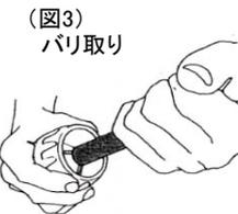
③ バリ取り 切断した銅管はフレア作業を行う前に必ずバリ取り作業をしてください。その際、切り粉がパイプの中に入らない様に注意してください。(図3)
