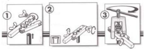
銅管をヨークに挟み 込んだら蝶ネジを ヨークのスロットに 合わせていれます。
