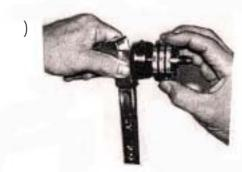
ガイドプレートヘッドを時計方向に止まるまで締めます。
