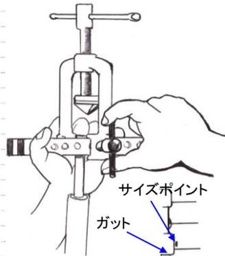
④ ガットをクランプバーに差し込み、はさんだ銅管の真上にフレアーコーンを持ってきます。ガットとクランプバーに刻んであるサイズポイントをあわせ、クランプハンドルを締め付けます。
