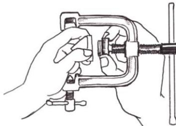
② フレアーコーンをアダプターナットの先端にねじ込んで取り付けます。
