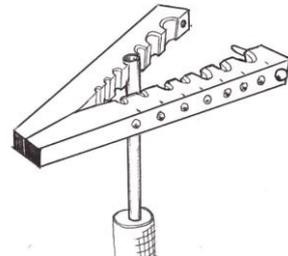
③ クランプバーを開いて銅管を表示のサイズ穴に入れ、クランプバーを軽く手で締めます。
