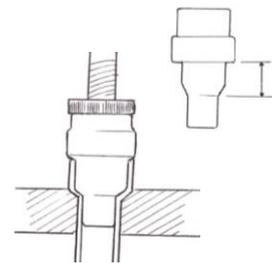
\* スエイジングをする場合は、銅管をバイス表面より、アダプターの首下の長さ分を出してクランプしてください。
