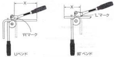
曲げ始めの寸法 X をチューブの右端から測って" R "マークに合わせてからハンドルを90°回します。
