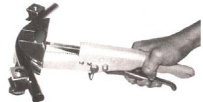
5. 曲げ終わったら、リリースレバーを右に切換え、手でシューを元の位置に戻して下さい。パイプが取れます。
