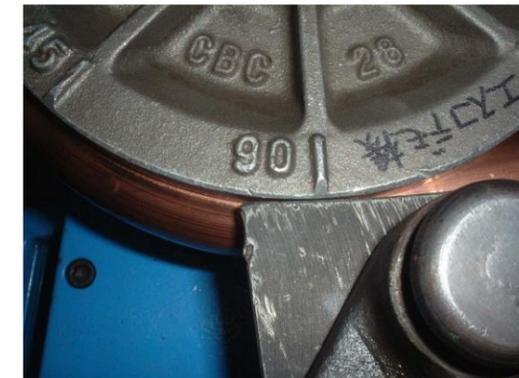
まず、ガイドの銅管が当たる箇所に潤滑スプレー等を塗布し、ガイド面の汚れや不純物を除去して下さい。ガイド面に銅管のカスやスケールなどが付着したまま作業をすると、銅管表面を傷つけ、破管の原因につながることがあります。
