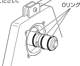
4 Oリング交換後分配器は内面にキズをつけないよう逆の手順で気をつけて取り付けてください。
