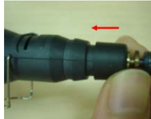
⑪ナットを締め付ける
