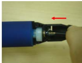
⑦新しいオリフィス組品を組み入れる
