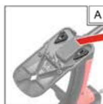
付属のサイドインサートを取り付ければ、機器の側面を接地させずに置くことができます。
