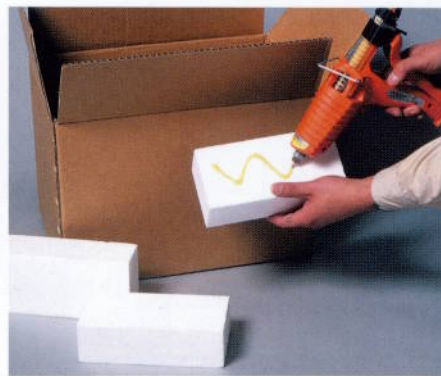
緩衝材の接着
