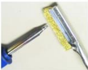
ストレートブラシで酸化物を除去します。
