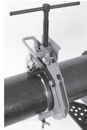
Figura 5 – Alineamiento de dos tubos
