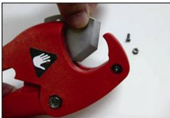
4)新しい刃を同様の方向から挿入します。
