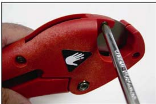
1)ネジと六角ナットを外します。
