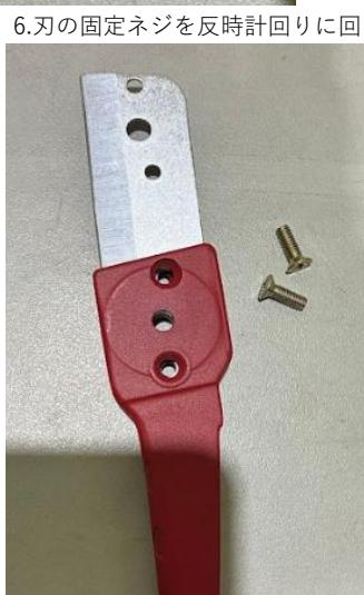
6.刃の固定ネジを反時計回りに回して外して下さい。
