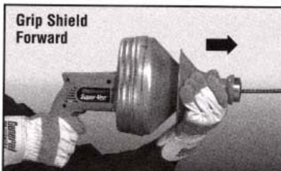
5. グリップシールドを後方に引きトリガーをにぎってモーターを回転させ再び排水管の方へ動かして下さい。
