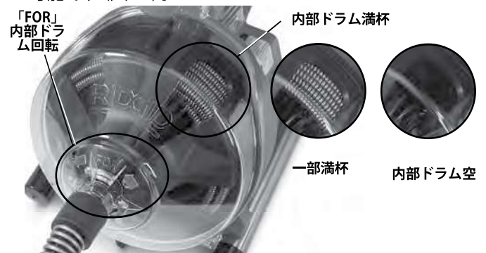
図 10 - 内部ドラム内のケーブルの監視
