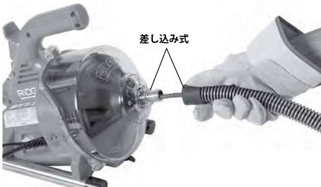
図4 - ケーブルをガイドホースに通す
