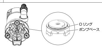
①ポンプベース下部の⊕ネジ(3ヵ所)を外します。上部にOリングがあるので無くさないよう注意してください。
