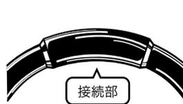
ケーブルの接続部は、水が浸入しないようにしっかりとモールド加工してください。
