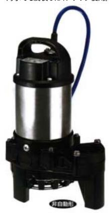
吐出し口径50mm出力 kw0.4kw相・電圧三200 V全揚程9.3/10.0m吐出し量0.08m³/min始動方式じか入れ
