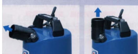
13mmボックスレンチ1本で吐出し方向「上」「横」を変更可能、横引き時のホースの折れ曲がりを防止します。しかも取付穴が切り欠き状のため、袋ナットを緩めるだけで脱着可能です。
