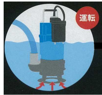
水位上昇を電極が検知し、再び排水開始
