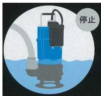
水位低下を電極が検知
