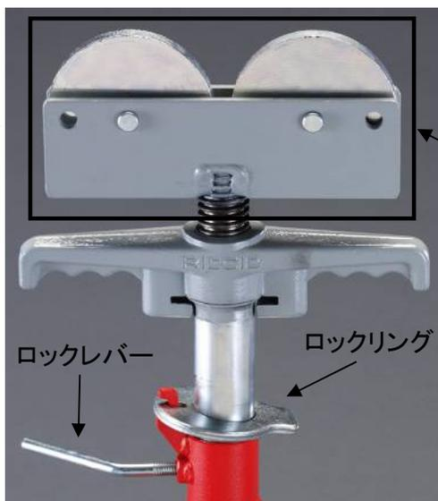
ローラーヘッドを持ちながらロックレバーを緩め、ロックリングをスタンドに対して平行にし、高さを調整して下さい。
