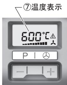
☞ 設定温度に向けて温度が高くまたは低くなっている間“°C”の表示は点滅しています。設定した温度に達すると“°C”の表示が連続点灯になります。
