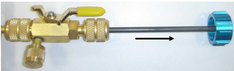
2. バルブコアリムーバーのダイヤルを押し込んでゆっくり回し、先端割れピンでバルブコアを探ってください。
