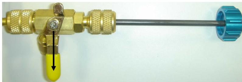
6. ガスの流出を止めてから、シャフトのナットを外し、バルブコアを外します。
