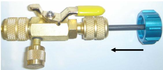
3. バルブコアリムーバーのダイヤルをゆっくり矢印の方向に回し、バルブコアを抜き取ります。
