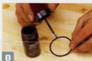
⑧後処理液WATER PROOFING SOLUTIONを接合箇所 thinly 塗ります。この時、厚く塗るとリングにガタができてしまいますので、できるだけ薄く塗って下さい。5～10分程度置いておき、後処理液が乾いたら完成です。
