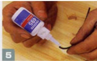
⑤接着剤を塗ります。片方の切断面に付属の接着剤495をごく薄く、均一に塗ります。接着剤は少量にしておくのがキレイに塗るコツです。もし、接着剤がハミ出ってしまったら綿棒などで拭き取って下さい。
