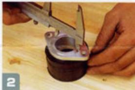
②使用対象物からゴムコードの長さを出します。古いO-リングが付いていればその長さを測れば良いですが、新しい場合は、単純に直径から計算してもゴムが伸びる分リングがやや大きめになってしまうので注意して下さい。
