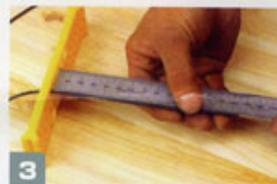
③ゴムコードを測ります。付属の治具の穴にコードを通してスケールをあてます。治具の板厚も計算に入れることを忘れないで下さい。また、直径からそのままの長さを出した場合は、コードを引っ張りながら測ると、ちょうど良い長さになります。
