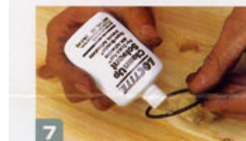
⑦接着剤が乾いたら治具からコードを外します。接合箇所から接着剤がハミ出ているなら、洗浄液CLEAN-UPSOLVENTを少量塗り、ウエスで拭き取って下さい。
