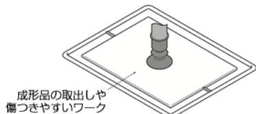
パッドホルダに真空取出口を両側に設けたタイプを用意。
