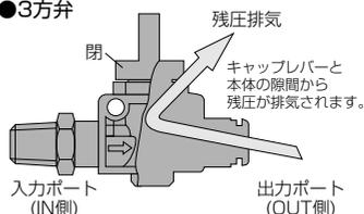
■ 3方弁と2方弁の識別方法
