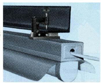
チェーン・器具付用 蛍光灯・配線器具・火災感知器などの取付に 許容静荷重…49N(5kgf) 適用寸法(A)…L・H形鋼用(鋼材厚15mm迄) 適用ビスサイズ… 3.1~ 4.1mm ビス適合長さ…10~15mmまで
